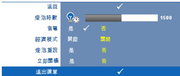
**燈泡時數** —顯示從燈泡計時器重新設定後開始運作的時數。
