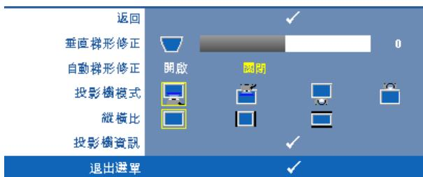
**垂直梯形修正** — 修正因投影機擺設角度所造成影像變形。
